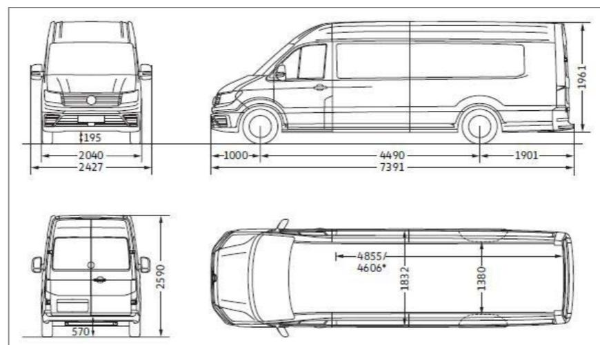
Les dimensions utiles sont valables pour des versions Traction. Sur les versions 4MOTION, la hauteur utile ainsi que la taille des ouvrants du compartiment de charge sont diminuées de 100 mm.
