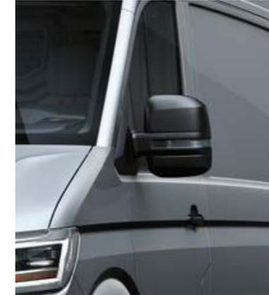
Rétroviseur extérieur convexe avec clignotant à LED intégré et zone grand angle
