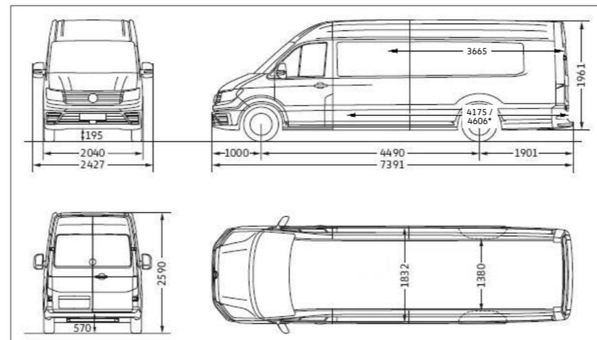
Les dimensions utiles sont valables pour des versions Traction. Sur les versions 4MOTION, la hauteur utile ainsi que la taille des ouvrants du compartiment de charge sont diminuées de 100 mm. \*250 mm sur 4MOTION et Propulsion
