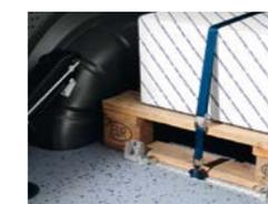
Sangle de fixation avec point d'ancrage
